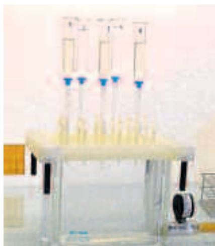
Análisis de micotoxinas en piensos y sus materias primas. De izquierda a derecha, extracción, y purificación en columna de inmunoafinidad.
