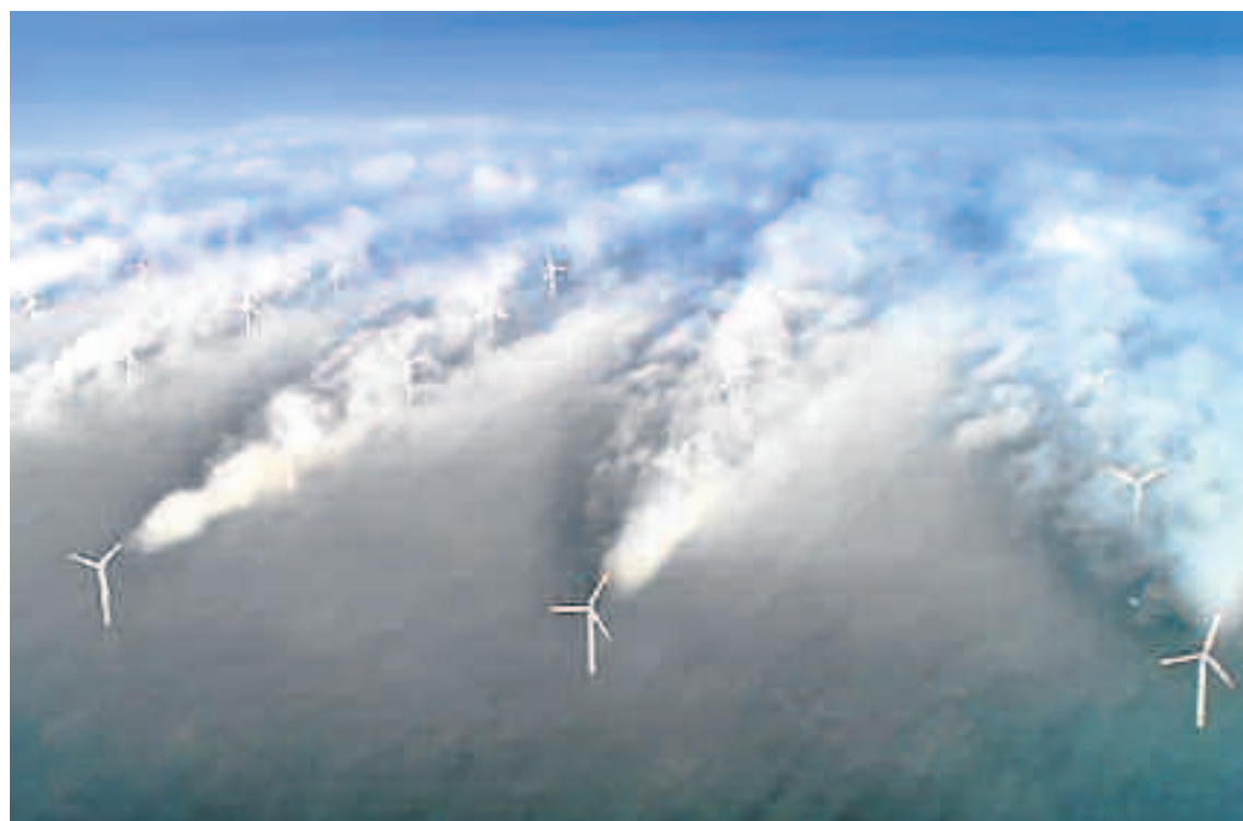
UNA FOTO CURIOSA. Fue tomada el 12 de febrero de 2008, en el campo eólico Homs Rev 1, en el Mar del Norte. A la 1 de la tarde, la extrema humedad del aire, en unas condiciones meteorológicas excepcionales, facilitaron la creación de condensación por las turbinas, en lo que se considera como una constatación empírica del modelo de turbulencia descrito para turbinas eólicas.
